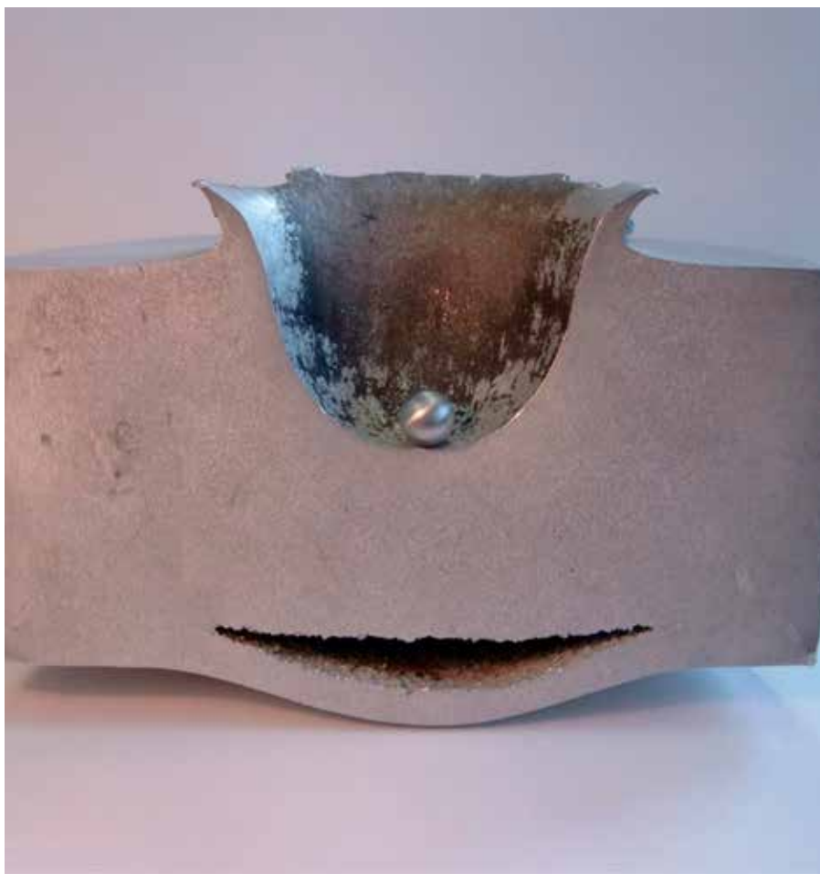
I danni provocati da una piccola sfera in alluminio di 1,2 cm di diametro alla velocità di 27.000 km/h in un blocco di alluminio da 18 cm di spessore. Pressione e temperatura che si sono sviluppate durante l'impatto hanno superato quelle che si trovano all'interno della Terra.
